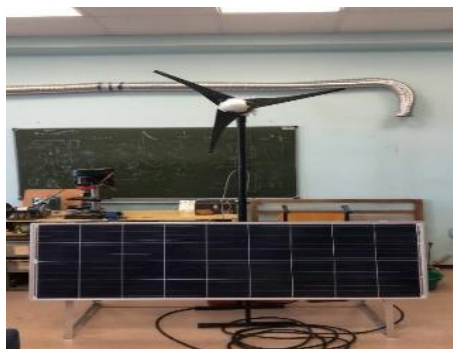
Рисунок 2 – Гибридная станция мощностью 650 Вт на базе лаборатории КГЭУ.
