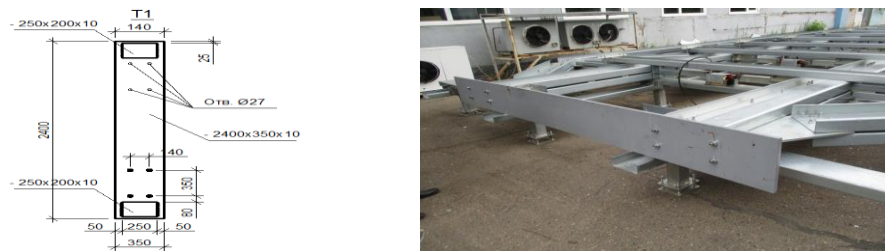
Рис. 2. Листовая сталь в опорной части ферм
