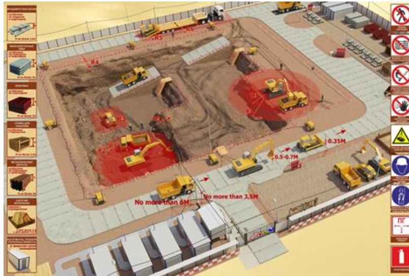
Рисунок 2. Трехмерный плакат по безопасному производству работ
