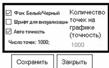
Рис. 5. Окно управления графиком: изменения фона и цвета графиков, функция автоматического или самостоятельного выбора количества выводимых точек на спектре частот, изменение шрифта для подписи.
