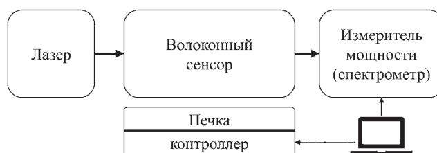
Рис. 2. Общая схема экспериментальной установки, содержащая широкополосный источник света, печь с контролем температуры и измеритель мощности.
