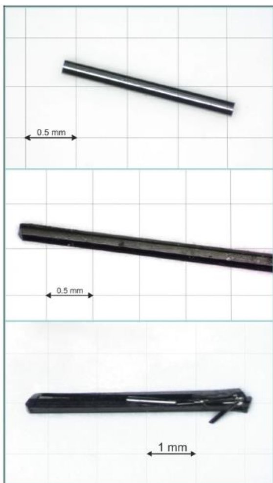
Рис.1 Монокристаллы, выращенные из системы (1): a - q = 0 , b - q = 1,12 , c - q = 1,96
