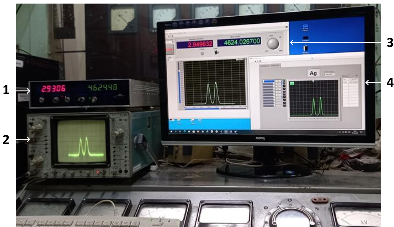
Рис. 2. Система контроля основных параметров имплантации ИЛУ-3: (1) цифровой интегратор, (2) осциллограф С1-83, (3) окно ППО СКПИ и (4) окно программы расчета ионного спектра.
