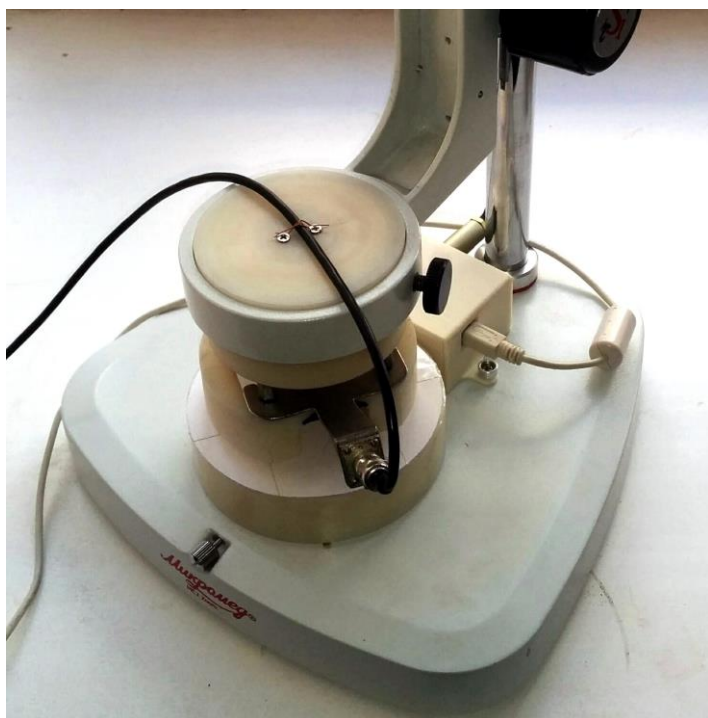
рис. 4 Устройство на платформе с промышленной 4-х зондовой головкой
